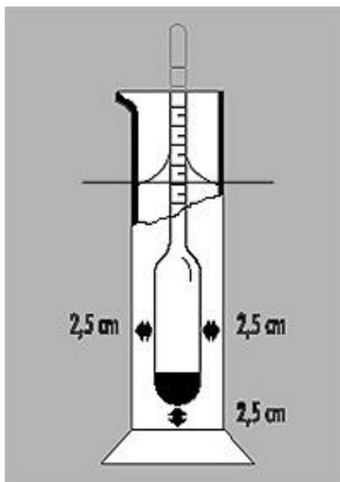
Рисунок 1. Прибор для измерения плотности приготовленных растворов солей.
